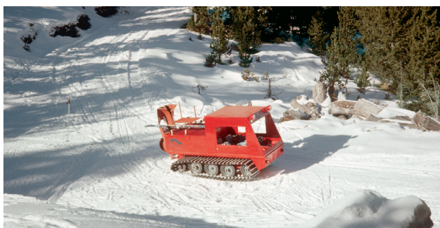
Pista del Gallfer al Llau dels Tarterals a l'Eixida de Montnartró (cota 2.100 m) amb la màquina eruga construïda ad hoc l'any 1976 per marcar les pistes d'esquí nòrdic. Va ser la primera i única de construcció íntegrament nacional. Foto C. Udina. Desembre 1977
